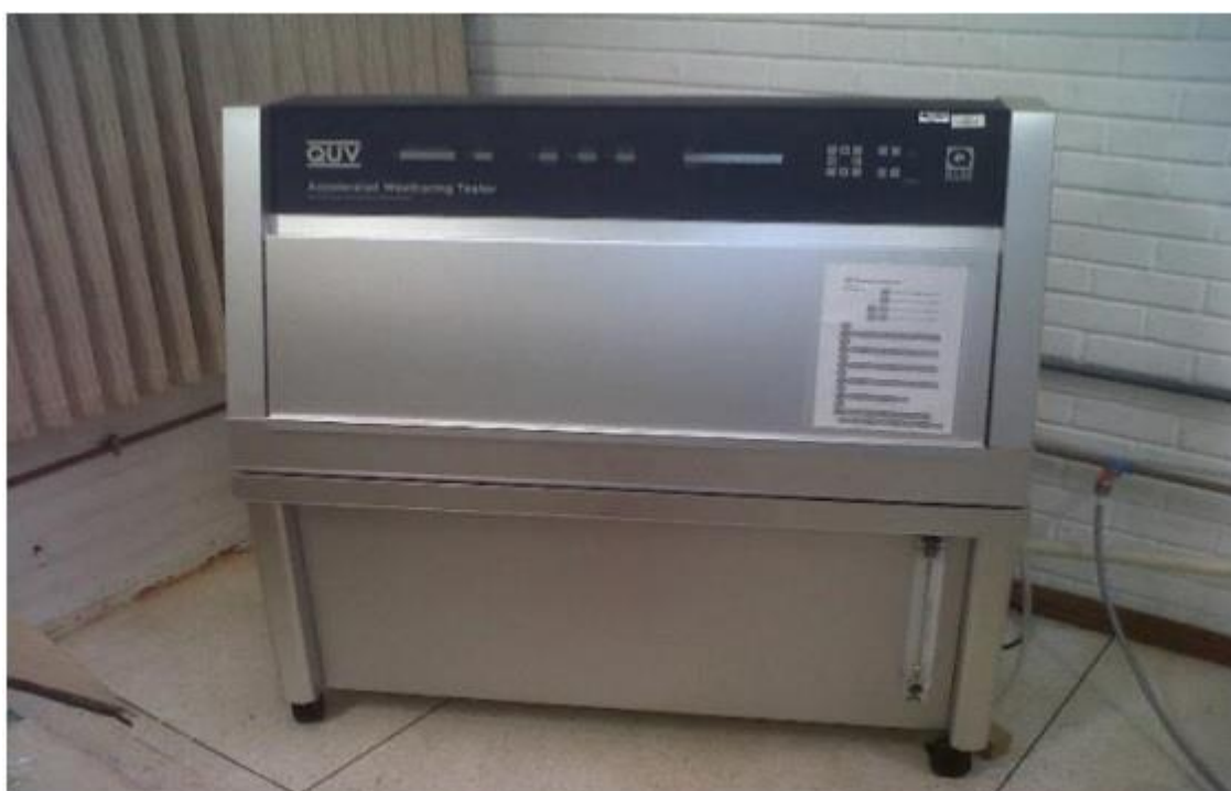
Figura 4.3: Câmara de envelhecimento QUV Q-Lab, modelo QUV/spray. Fonte: MESQUITA, 2016.
