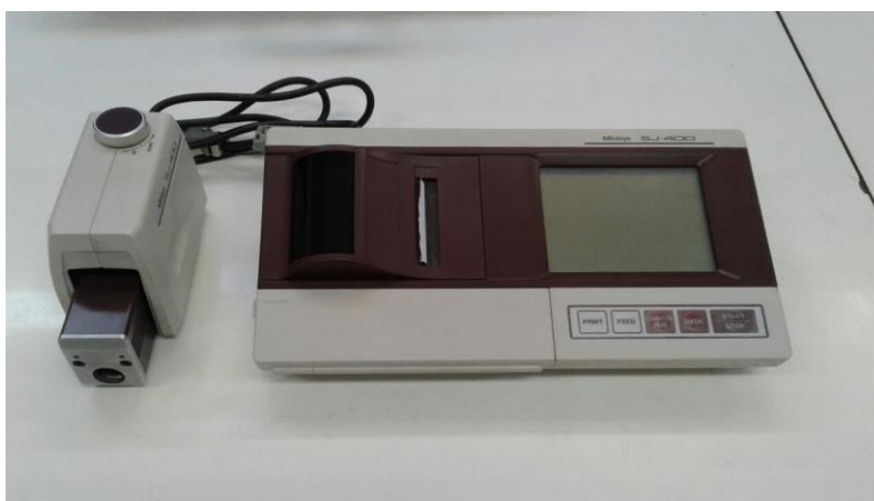
Figura 4.1: Rugosímetro Surftest SJ – 400 Mitutoyo.
