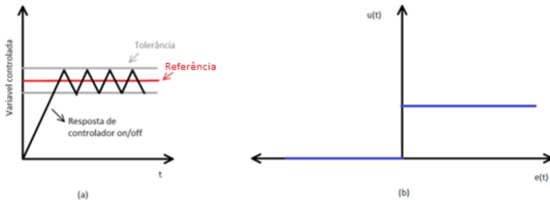
Figura 9: Esboço do comportamento de um sistema controlado por on/off. (a) variável controlada em função do tempo. (b) saída do controlador em função do erro atuante.
