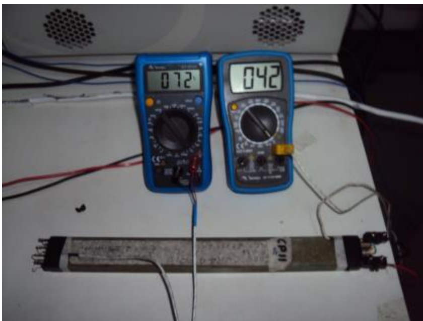
Figura 35: Experimento evidenciando gradiente de temperatura ao longo do fio de SMA.
