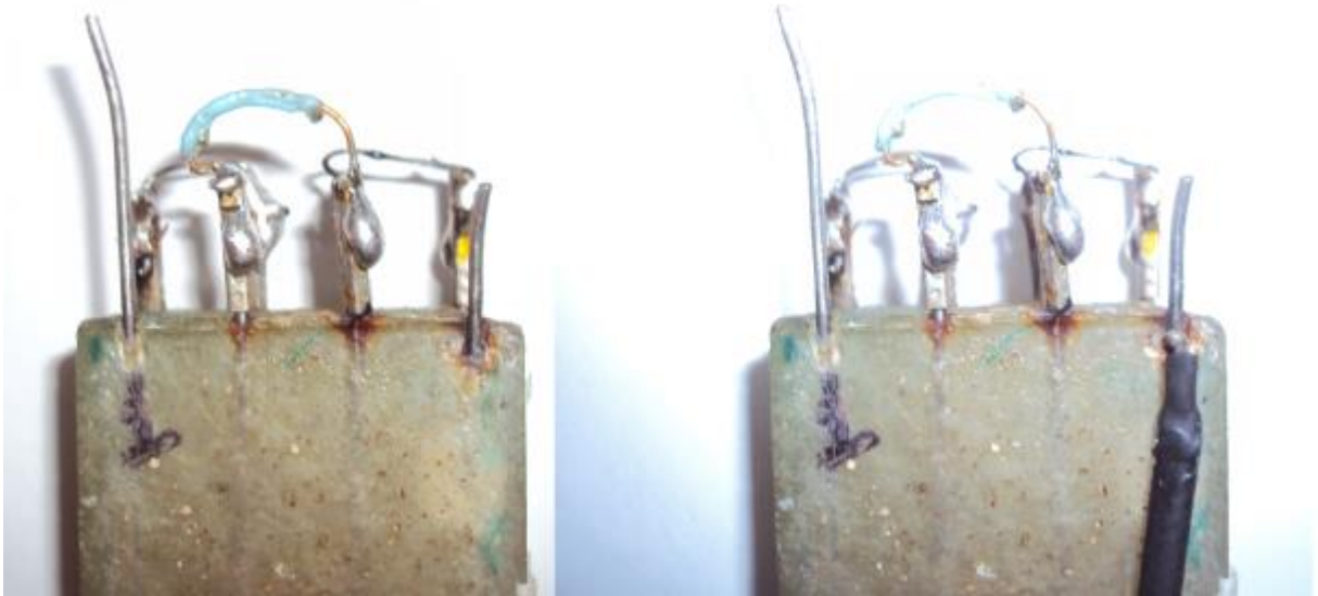
Figura 29: Detalhe demonstrando parte do fio exposto sobre a viga (à esquerda) e o posicionamento do termopar sobre o fio (à direita).
