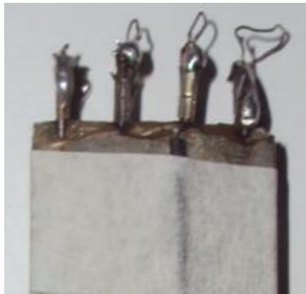
Figura 30: Detalhe mostrando a fixação do termopar na ponta 2 da viga.
