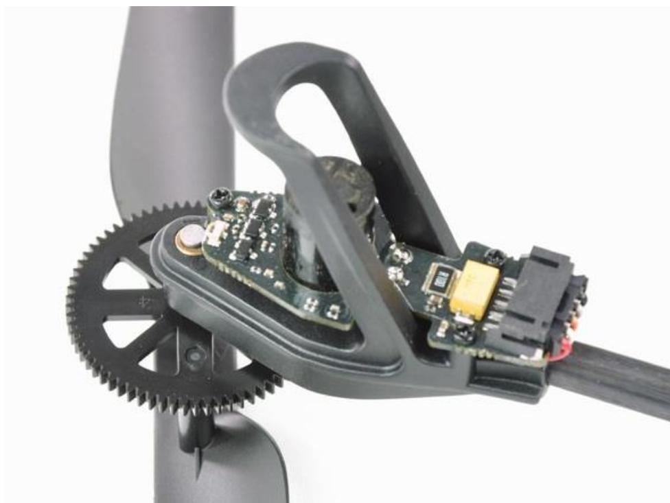
**Figura 2.7** - Conjunto motor, hélice e circuito controlador. Figura extraída de [10].
