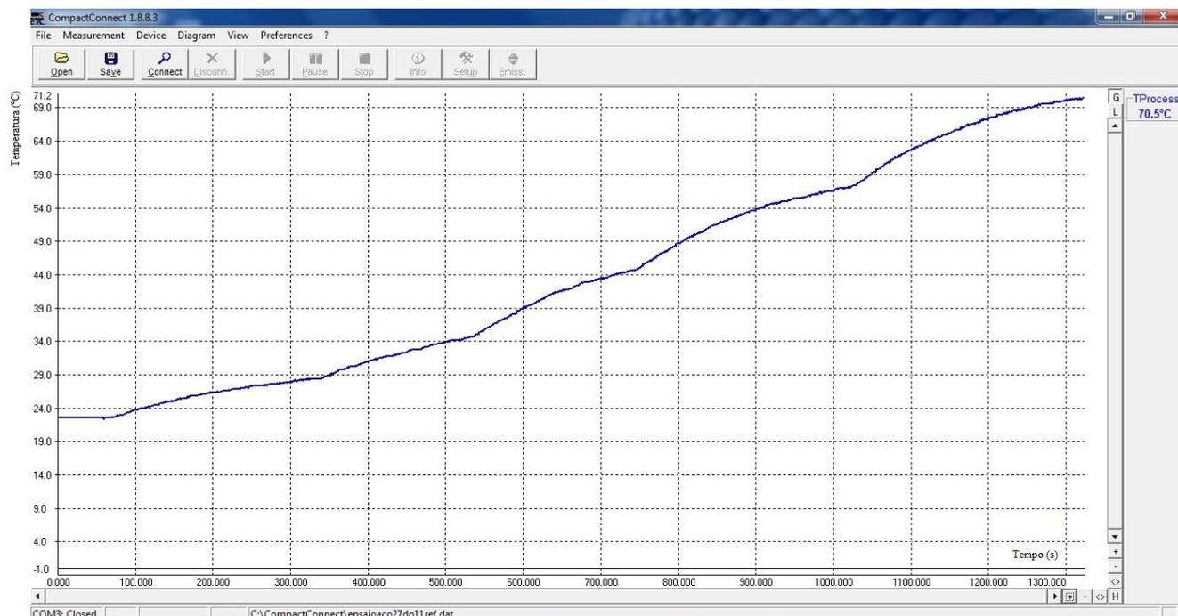
**Figura 5.8 – Software Compact Connect, curva temperatura x tempo para os ensaios com aço.**
