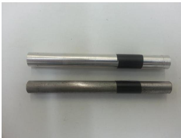
**Figura 3.5 – CPs preparados com fita isolante agindo como material de emissividade de referência.**
