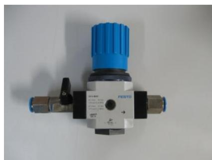
Figura 6.6. Válvula manual para ajuste de pressão.
