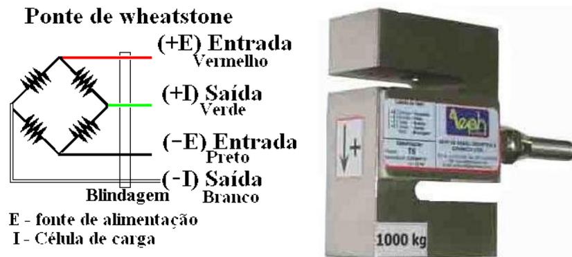
Figura 6.9. Célula de carga.
