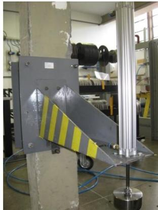
Figura 6.1. Suporte para atuador pneumático.
