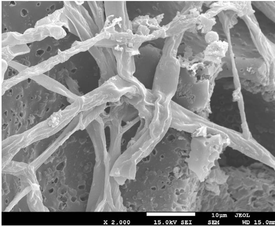
**Figura 22:** Superfície do carvão ativado com o biofilme de *Aspergillus* (Ampliação 2000x).
