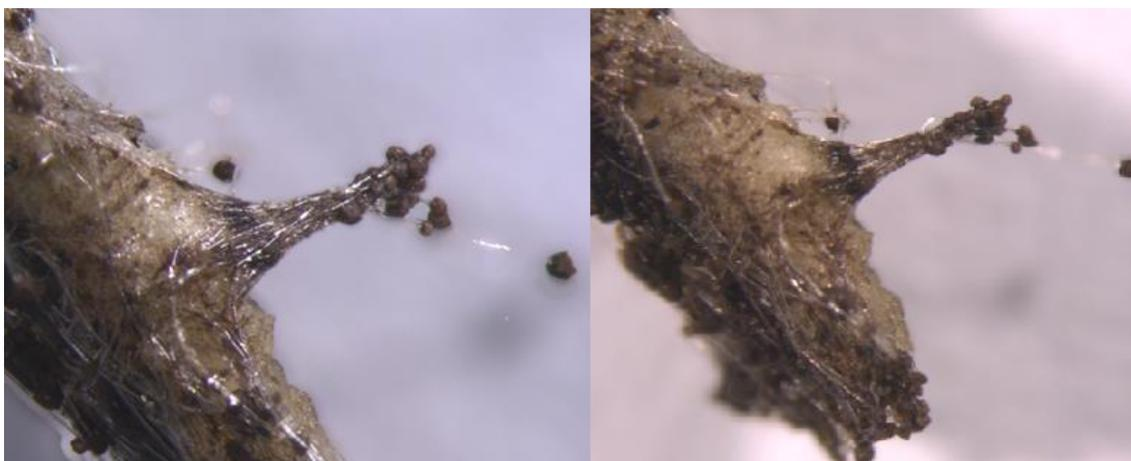
**Figura 24:** Imagem gerada por Lupa eletrônica para a superfície do carvão mais biofilme de *Aspergillus niger*.
