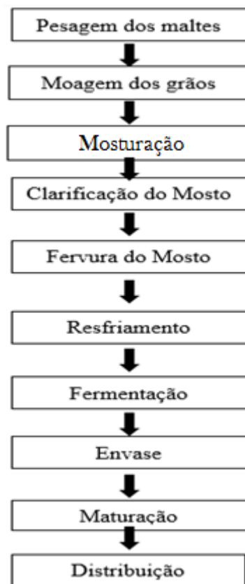
Figura 1: Fluxo de produção de cerveja. Fonte: Adaptado, KUNZE, 1999.
