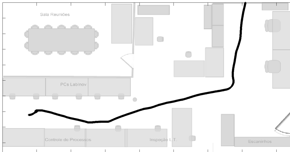
Figura 4.19: Resultado de localização para os dados colhidos no experimento citado anteriormente e ilustrado na Fig. 3.26, utilizando sistema de localização com ARToolKit
