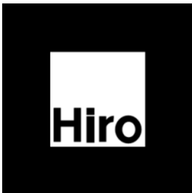
Figura 3.6: Exemplo de alvo de rastreamento para uso com ARToolKit
