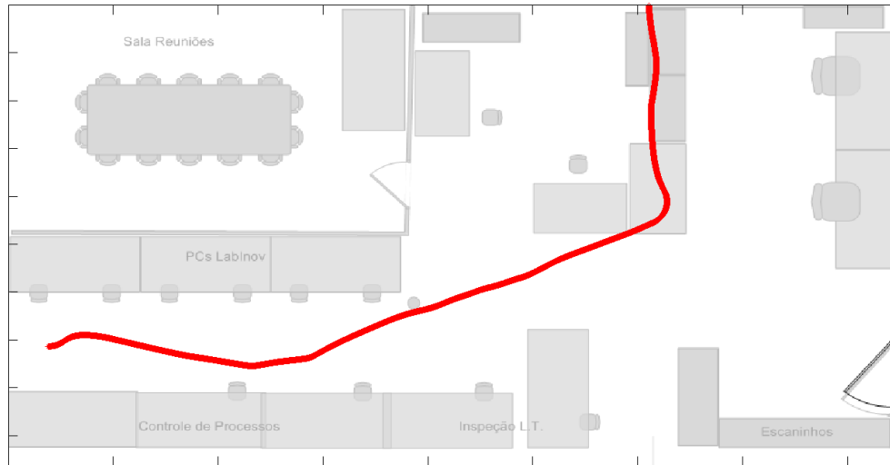
Figura 4.18: Resultado de localização para os dados colhidos no experimento citado anteriormente e ilustrado na Fig. 3.26, utilizando apenas odometria
