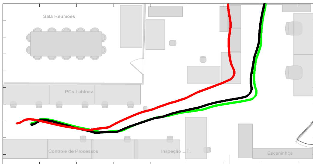
Figura 4.21: Resultado utilizando odometria sem correção (em vermelho), resultado utilizando ARToolKit (preto) e resultados utilizando o filtro com RFID (verde).
