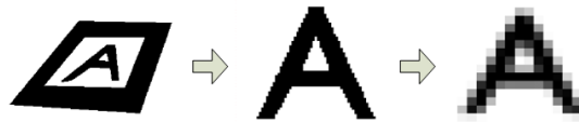
Figura 3.17: Processo de normalização e redução de resolução (fonte: adaptada de documentação online do ARToolKit )
