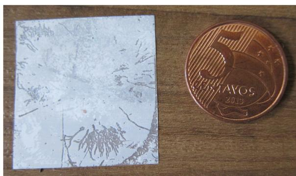
Figura 4.5: Substrato após ficar 10 minutos em acetona no ultrassom
