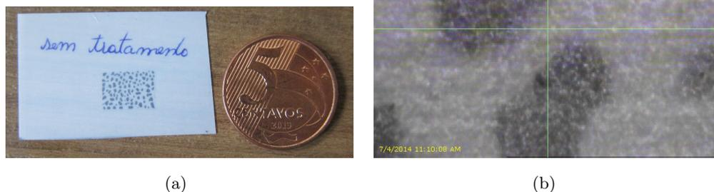
Figura 4.6: Substrato com deposição de PEDOT:PSS PH1000 puro sem tratamento para realizar a limpeza. 4.6(a) é a foto do resultado da impressão e em 4.6(b) a imagem da área impressa obtida pela câmera de referência
