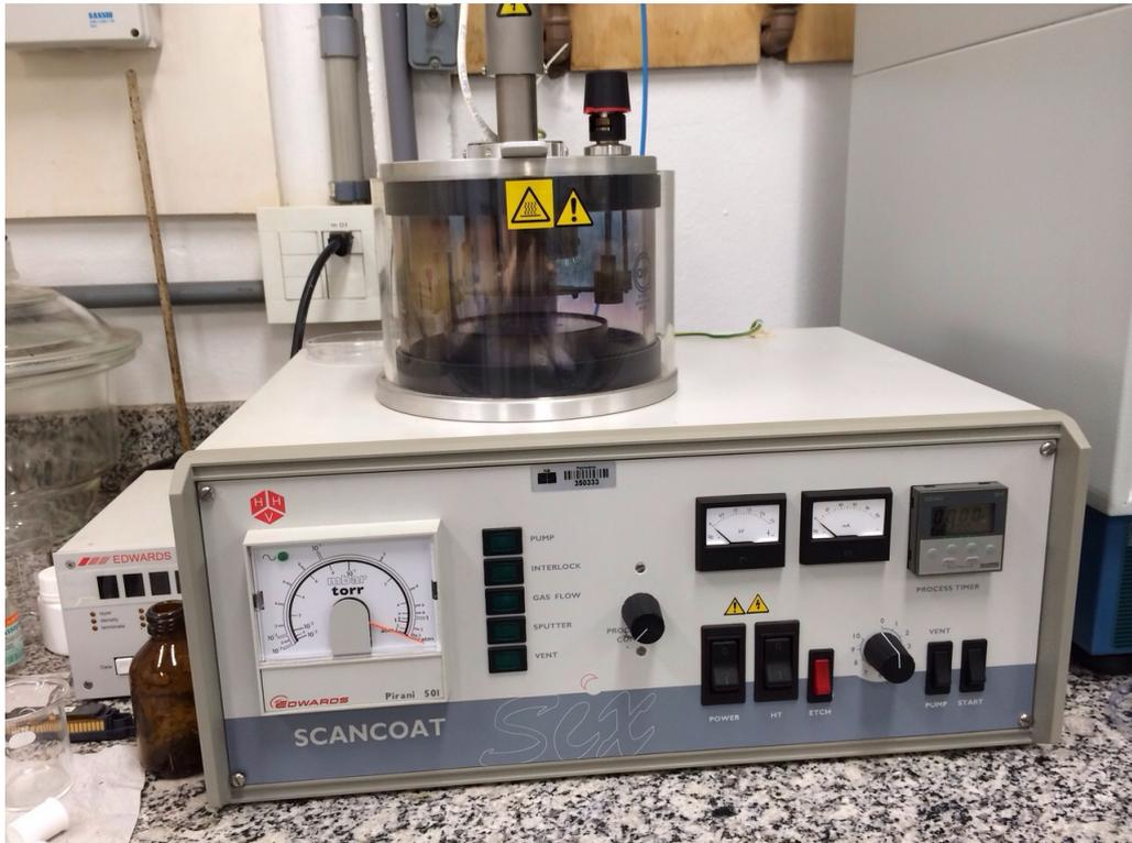
Figura 2.7: Equipamento para realização do *Sputtering*
