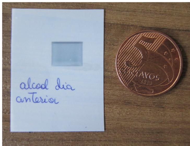
Figura 4.8: Substrato com deposição de PEDOT:PSS puro limpo por 15 minutos com álcool isopropílico no ultrassom e seco no fluxo de nitrogênio e impressão feita no dia seguinte.
