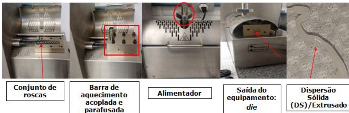
Figura 04. Termoextrusora (HAAKE MiniCTW) em escala laboratorial. Fonte: POP - Operação, manutenção e limpeza da Termoextrusora (HAAKE MiniCTW) do Laboratório (LTMAC)/UnB/FS; e adaptada de (MANIRUZZAMAN et al.,2012).
