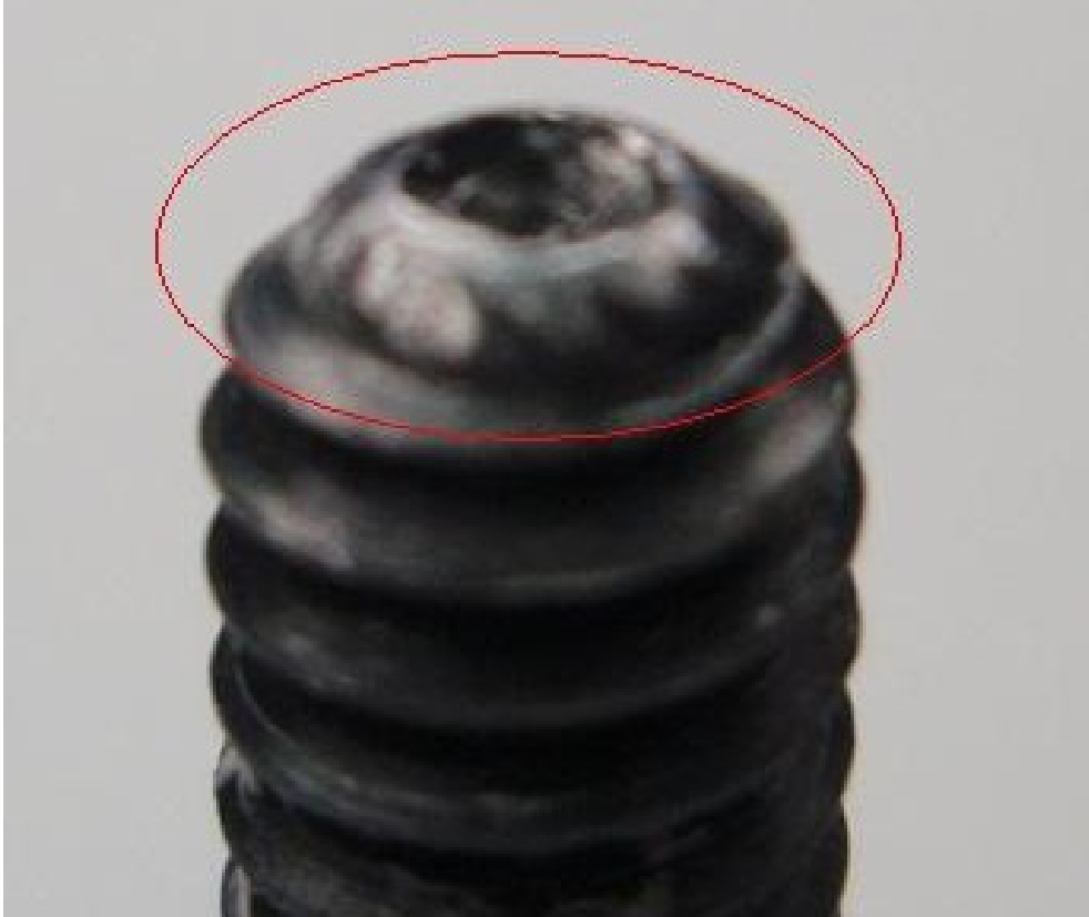
Figura 3.83: Parafuso de fixação depois de ser utilizado na prótese. As ranhuras da ponta se desgastaram e deformaram.
