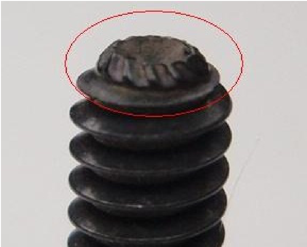
Figura 3.82: Parafuso de fixação antes de ser utilizado na prótese. As ranhuras na ponta (destacadas em vermelho) auxiliam na fixação.
