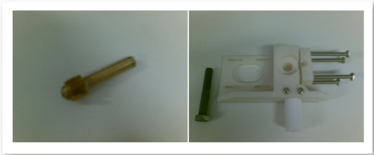
Figura 6.7: Bico da extrusora e estrutura de suporte com barreira térmica
