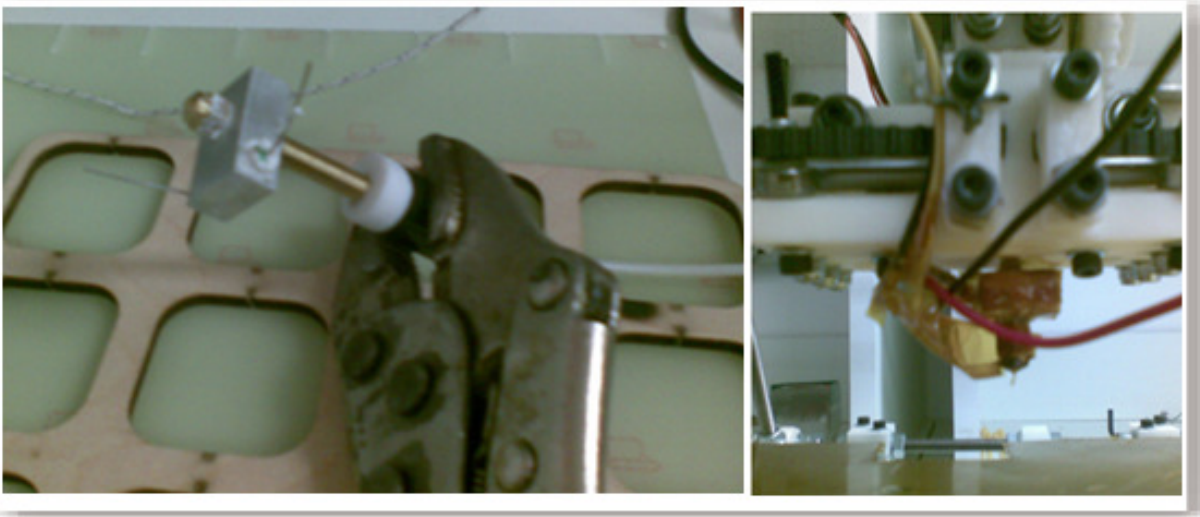
Figura 6.8: Extrusora com o bloco de aquecimento para teste e montada no eixo X
