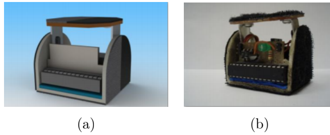
Figura 2.6: ErekoBot \alpha v.1 (a) design Prévio (b) implementação real
