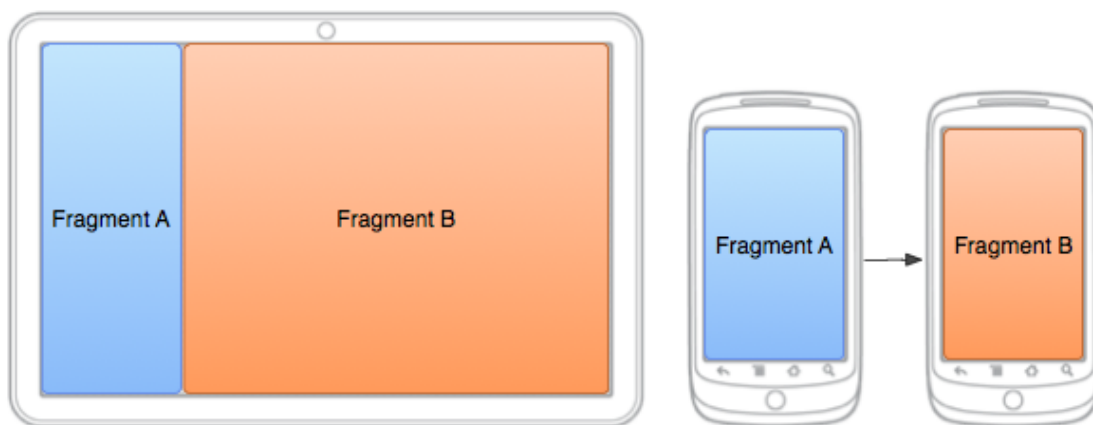
Figura 2.6: Modularização da interface gráfica através do uso de Fragmentos. Dependendo do tamanho disponível da tela, os fragmentos podem ser apresentados de maneiras diferentes.
