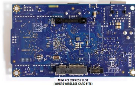
Figura 2.16: Descrição dos pinos da placa Galileo - parte traseira[2]
