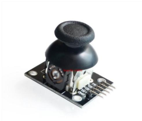
Figura 4.22: Circuito integrado de um joystick que utiliza dois potenciômetros para tradução de sua posição em tensão.
