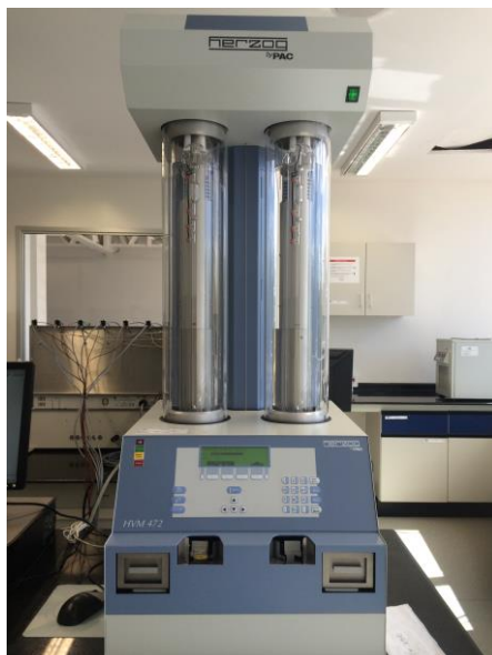
Figura 7. Equipamento usado para o ensaio de viscosidade cinemática a 40 °C.
