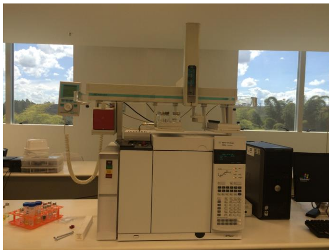
Figura 4. Cromatógrafo Gasoso usado para a realização do ensaio de teor de éster.
