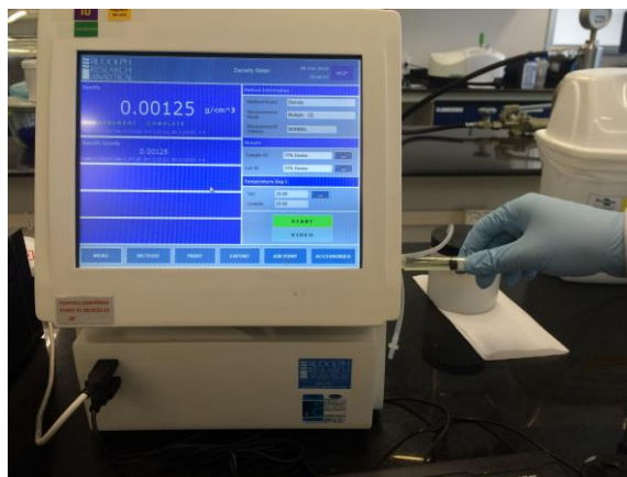
Figura 6. Equipamento usado na análise de densidade das amostras de biodiesel.
