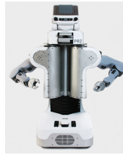
(b) PR2 - Robô desenvolvido pela Willow Garage para pesquisa acadêmica [8]
