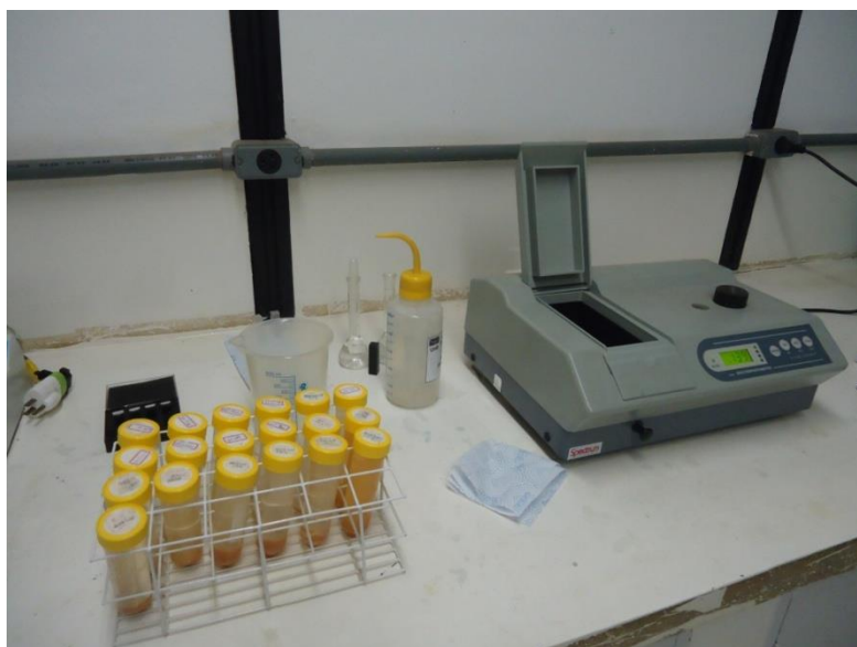
Figura 9. Leitura da transmitância por espectrofotometria.
