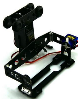
Figura 16 Gimbal de 2 eixos atuado por servo [23]
