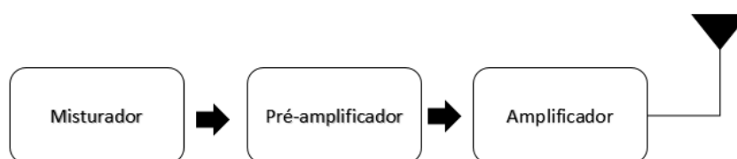
Figura 17: Diagrama do estágio de amplificação do transmissor TTE.
