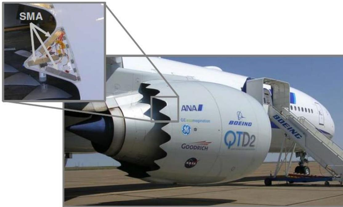
Figura 2.1. Aplicação de uma SMA, propulsor da Boeing com geometria variável. (NASA, 2015).
