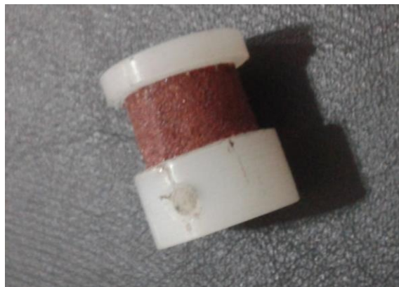
Figura 22 - Exemplo de polia com lixa para aumentar atrito com correia
