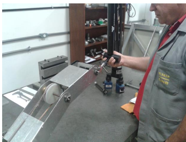
Figura 84 - Técnico operando o braço articulado para medições
