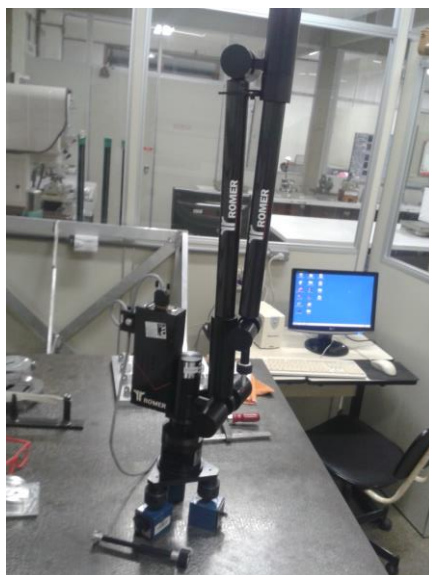
Figura 83 - Braço articulado para medição
