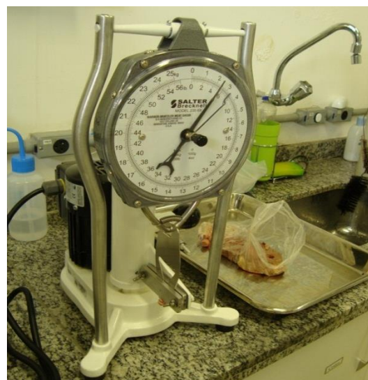
Figura 9. Aparelho Warner-Bratzler – mensuração da força de cisalhamento Fonte: Luana Frossard
