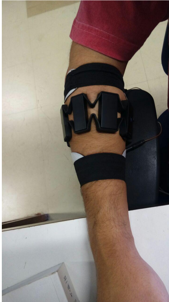
Figura 3.20: Durante os testes, foram usadas tiras elásticas para prender os eletrodos no lugar. Na imagem podem ser vistos os dois pares, do canal 1 à direita e do canal 2 à esquerda.
