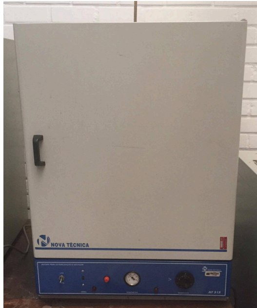
Figura 3. Estufa sem circulação forçada de ar empregada para a secagem da parte aérea e radicular de Achyrocline satureioides (Lam.) D.C.. Fonte: Nascimento (2016).
