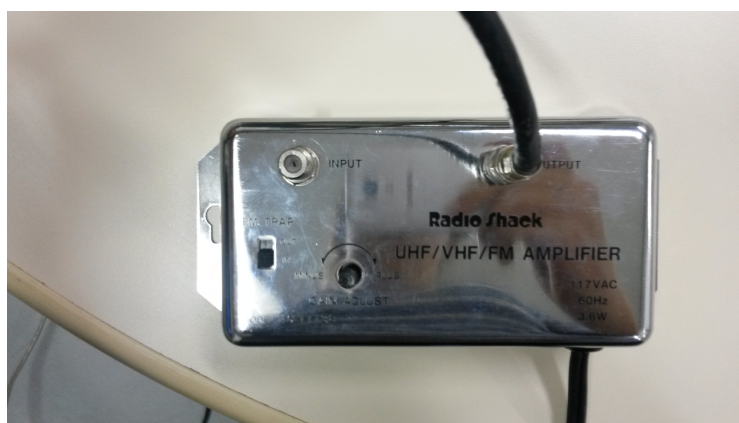
Figura 5.3: Amplificador variável de 20dB para Recepção de TVD
