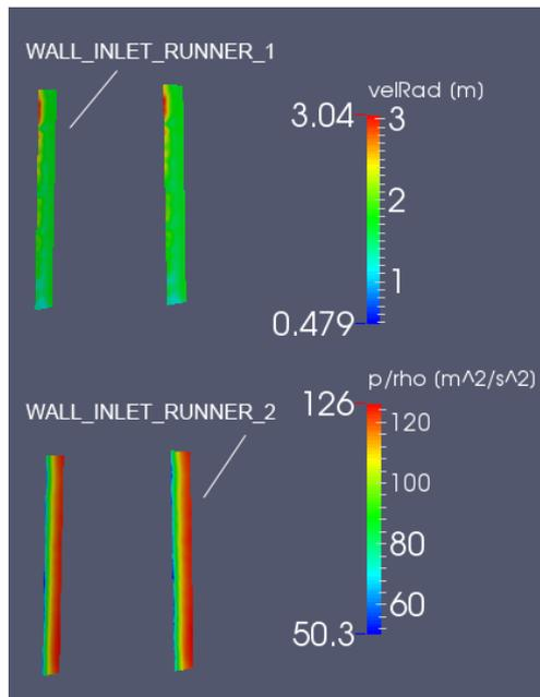
Figura 3.13: Distribuição dos campos de velocidade e de pressão em um dos pares de superfícies onde a condição `cyclicGgi` foi aplicada (`WALL_INLET_RUNNER_1` e `WALL_INLET_RUNNER_2`), considerando o Trecho 2 isolado e estático
