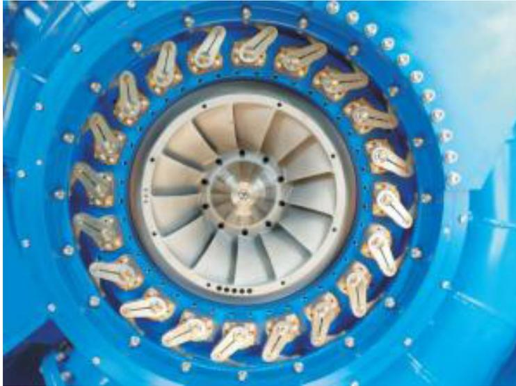
Figura 1.2: Anel distribuidor [7]
