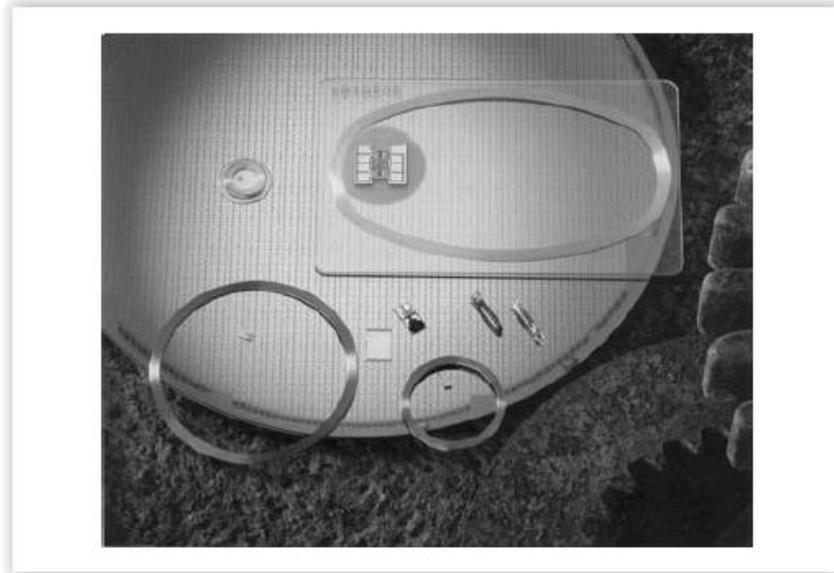
Figura 28- Os diferentes formatos de *transponders* indutivamente acoplados. A foto mostra *transponders* meio-acabados, ou seja, antes dos *transponders* serem inseridos em um encapsulamento de plástico. [1]
