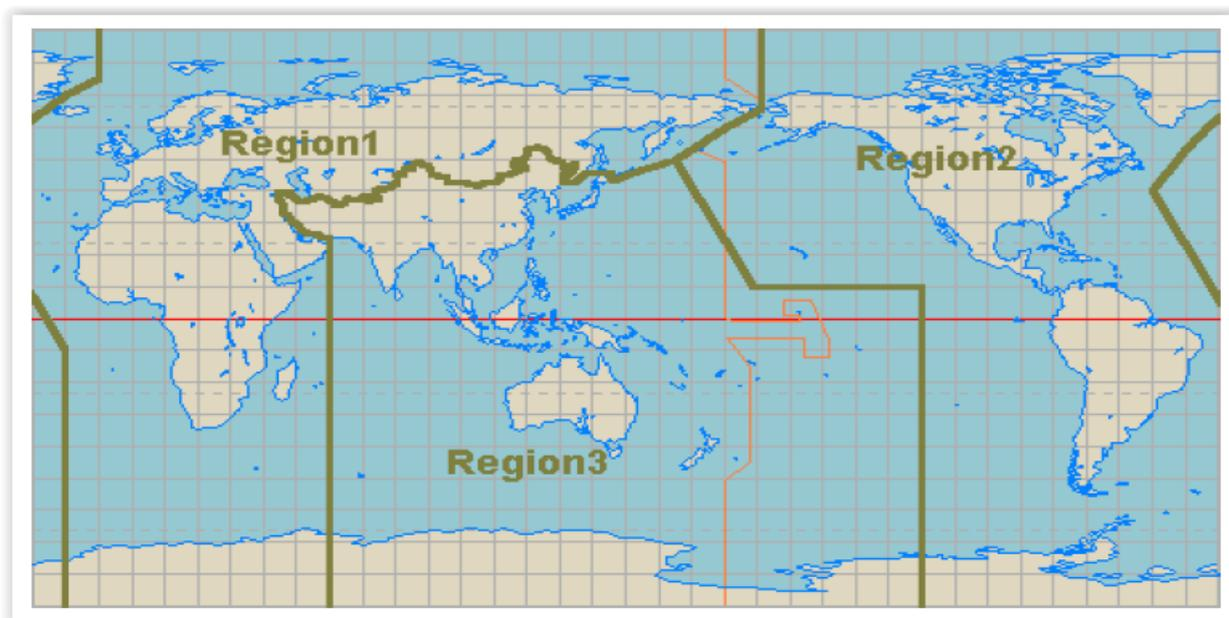
Figura 45 - Regiões regulatórias, segundo o ITU. [1]
