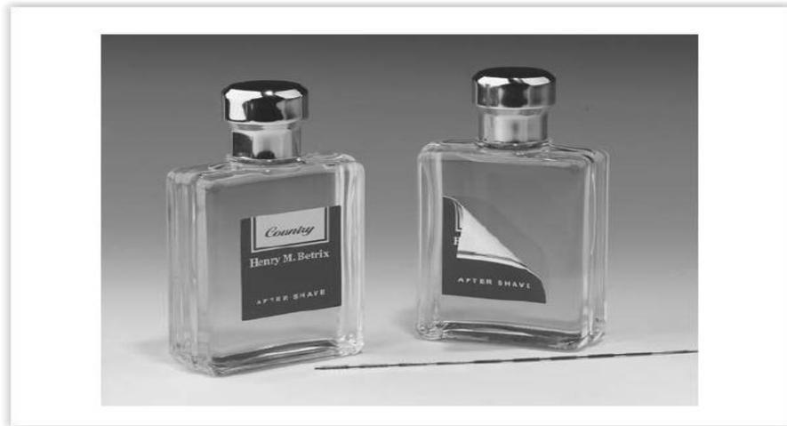
Figura 23 - Etiquetas eletromagnéticas em uso. [1]
