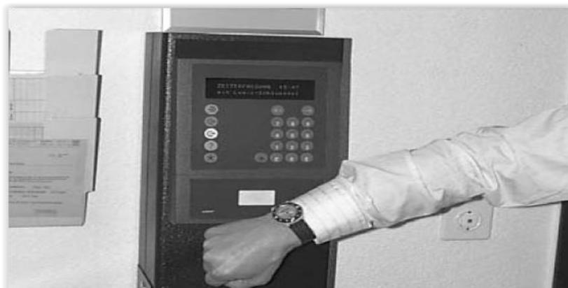
Figura 65 - Controle de acesso e tempo de manutenção são combinados em um único terminal. O relógio com um *transponder* integrado executa a função de um suporte de dados sem contato.
