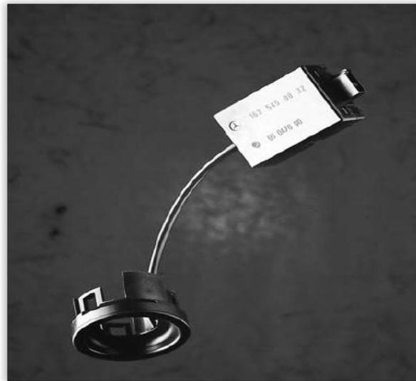
Figura 77 - A antena do sistema de imobilização eletrônica está integrada diretamente à fechadura da ignição. [1]
