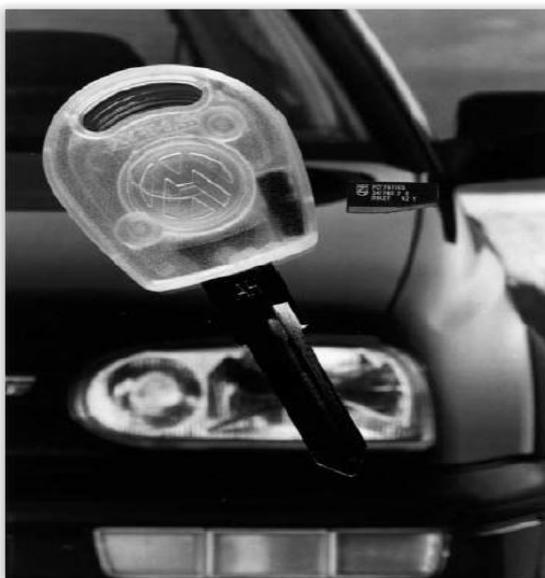
Figura 76 - Chave de ignição com *transponder* integrado[1].
