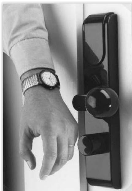
Figura 9 – Relógio com transponder integrante sendo usado em sistema de autorização de acesso sem contato. [1]
