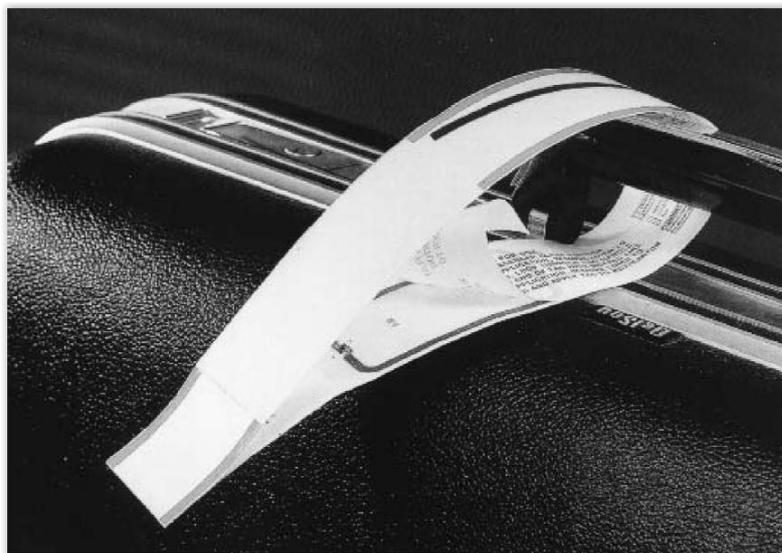
Figura 11 - Transponders de etiquetas inteligentes são finos e flexíveis o suficiente para ser anexados a bagagens sob a forma de uma etiqueta auto-adesiva. [1]
