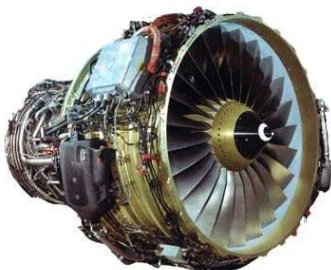
Figure 3. Moteur civil de la famille CFM56 propulsent de nombreuses versions d'avions d'Airbus (A320) et de Boeing (737). [1]
