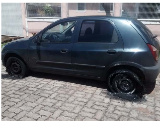
Figura 2.11 – Carro que ficou em contato com cabo energizado. [15]
