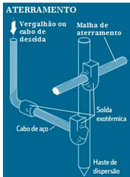
Figura 3.2 – Componentes de um aterramento convencional. Adaptado [16]
