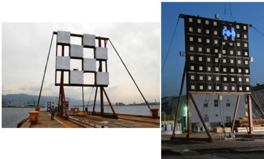
Figura 5.5: Antenas usadas no teste de transmissão de energia via microondas realizado pela JAXA e Mitsubishi Heavy Industries. A esquerda é mostrada a antena de transmissão e na direita a de recepção. [37]
