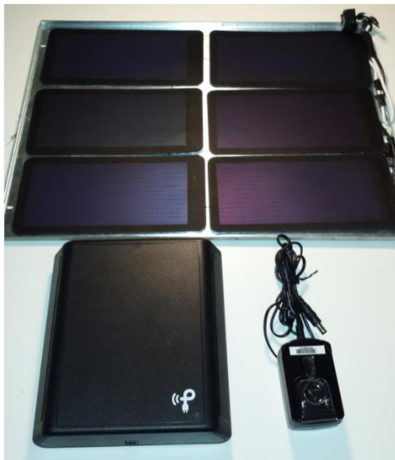
Figura 6.1: Módulo solar construído e conversor DC-RF e transmissor da POWERCAST
