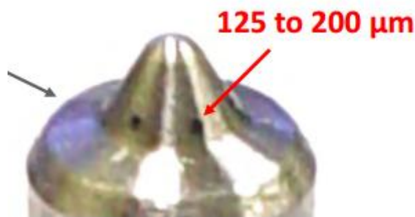
Figura 73 - Destaque para o diâmetro d_o de bicos injetores comerciais [60]
