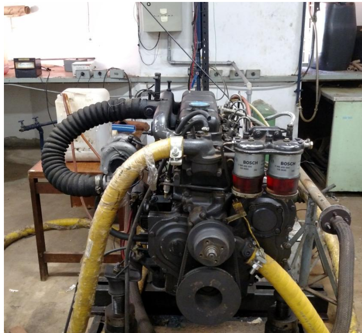
Figura 86 - Vista frontal do motor Perkins, montado na bancada dinamométrica em 05/05/2016.
