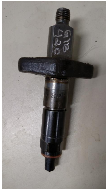
Figura 92 - Bico injetor Bosch utilizado nos ensaios de motor
