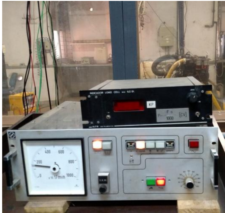
Figura 74 - Equação para cálculo de potência na caixa preta, controlador do dinamômetro na caixa branca
