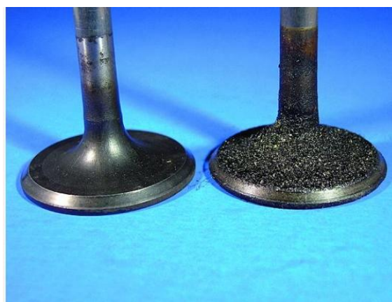
Figura 46 - Depósitos na válvula a direita
