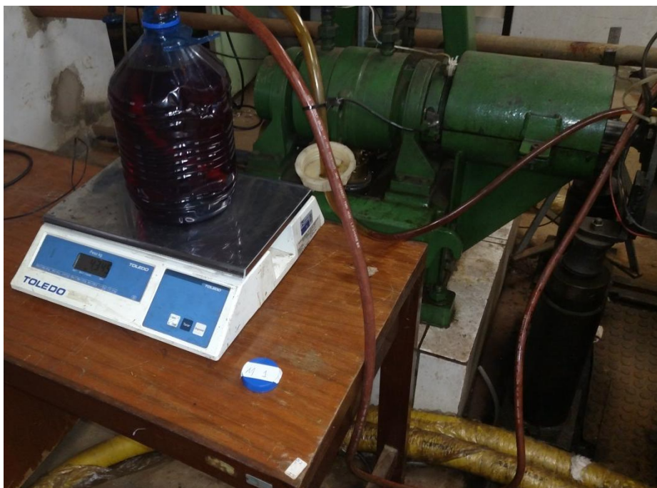
Figura 87 - Montagem do reservatório contendo a Mistura 1 (10AA15Macaúba75D), com aferição de massa feita pela balança e linhas de combustível em destaque, em 02/06/2016.
