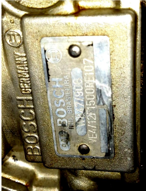
Figura 91 - Número de série da bomba Bosch utilizado nos ensaios de motor
