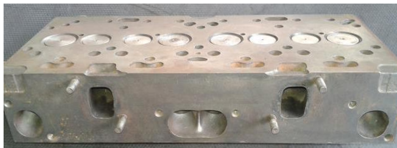
Figura 60 - Cabeçote do motor Perkins Q20B4.236, sem cavas
