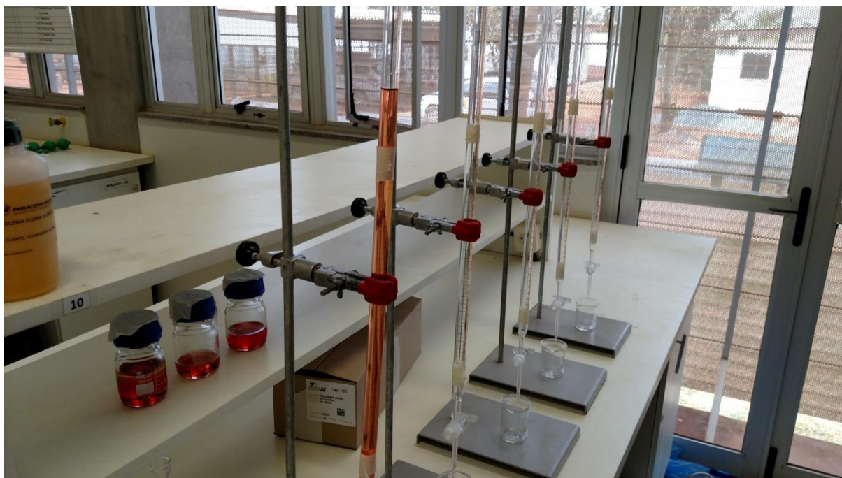
Figura 51 - Ensaio de viscosidade e marcas de referência na bureta
