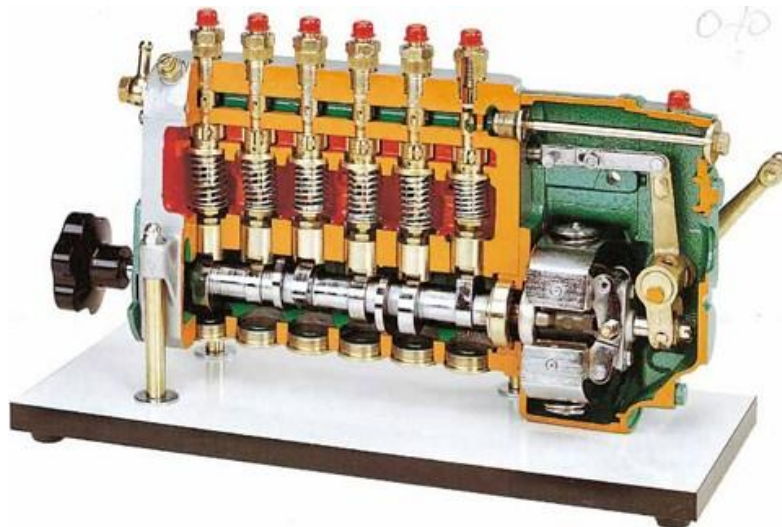
Figura 1 - Bomba de injeção mecânica em corte [58]
