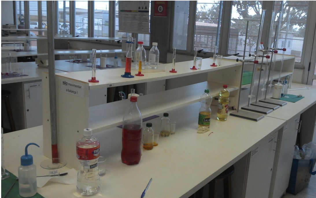
Figura 83 - Aparato para verificação de miscibilidade entre óleo Diesel S500, álcool anidro 99,5% e óleos vegetais. Ao fundo, buretas utilizadas no ensaio de viscosidade, em 22/04/2016.
