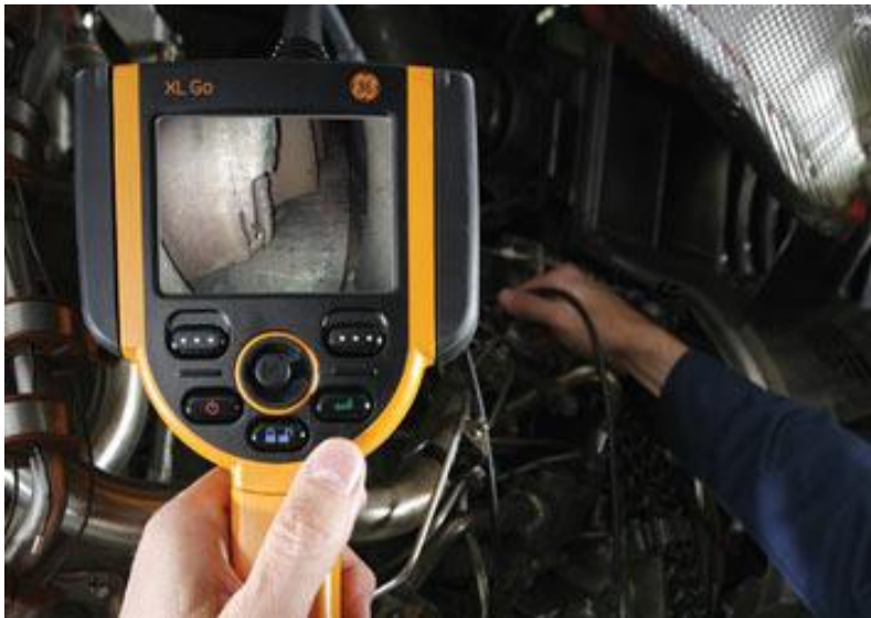
Figura 57 - Ilustração do Funcionamento do boroscópio [52]
