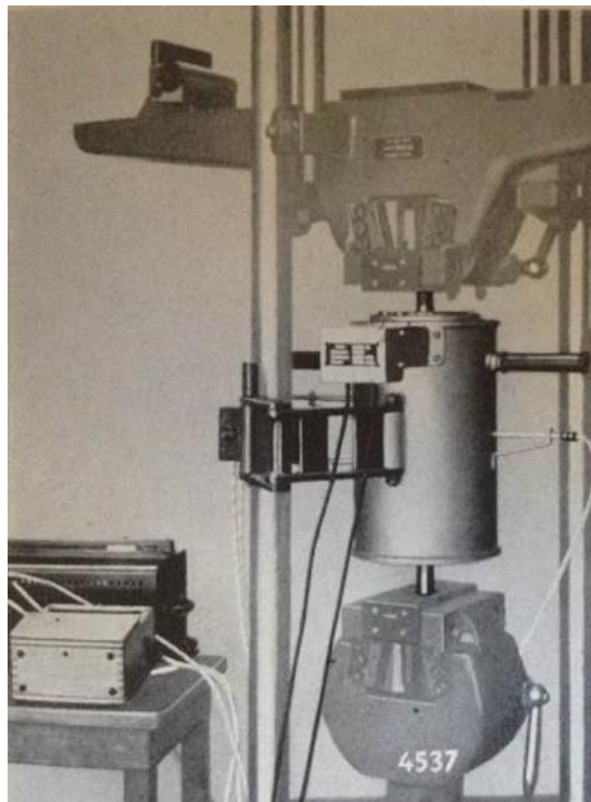
Figura 20. Teste de tração sendo realizado a 850 °C [1]
