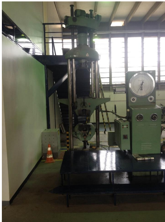
Figura 23. Máquina UHP 60 e o painel de controle instalados no edifício SG-9
