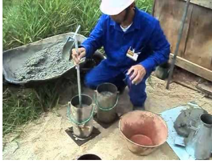
Figura 13 – Adensamento e moldagem de corpo de prova de concreto [12]
