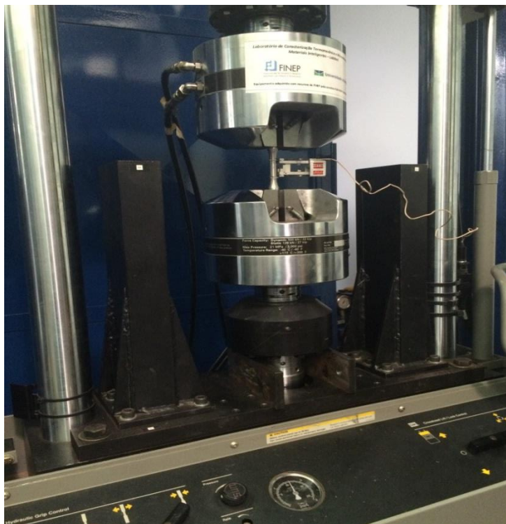
Figura 3.15: Corpo de prova montado juntamente com o extensômetro.
