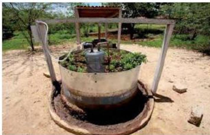
Figura 2.10 - Biodigestor caseiro, (Mattos, 2011).
