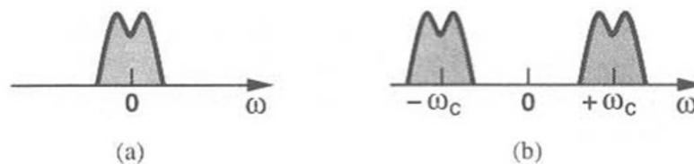
Figura 2.16: (a) Sinal em banda base. (b) Sinal modulado na frequência da portadora.
