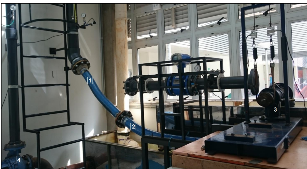
Figura 6 – Configuração final da bancada de teste turbina Kaplan.
