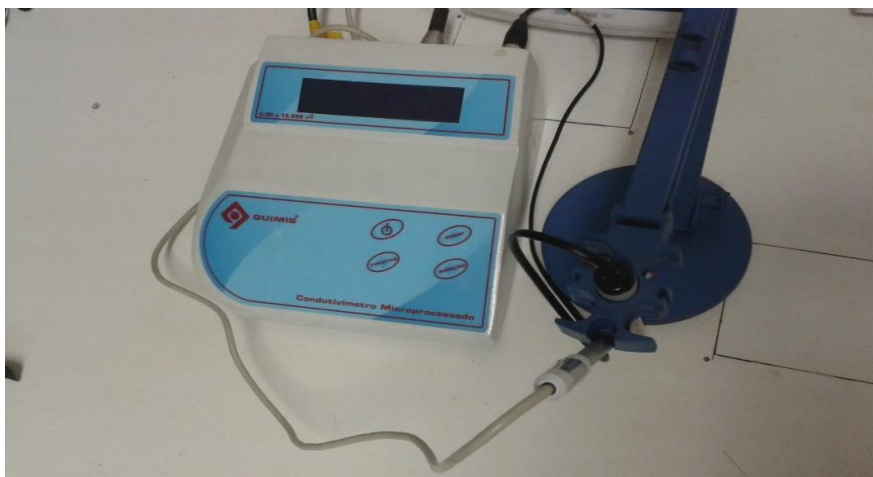
Figura 5: Condutivímetro de bancada empregado nas análises de condutividade elétrica de sementes de Pterogyne nitens Tul.
