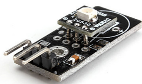
(a) Sensor de radiação ultravioleta UVM-30A. fonte: http://dx.com
