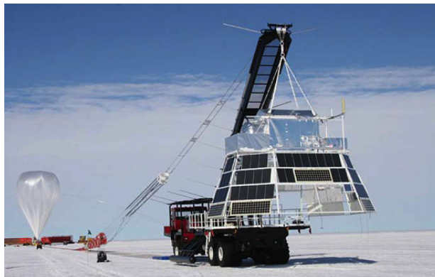
(b) Carga útil sendo erguida pelo caminhão grua antes do lançamento. fonte: http://csbf.nasa.gov
