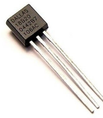
(b) Sensor de temperatura DS18B20. fonte: http://kiatronics.com
