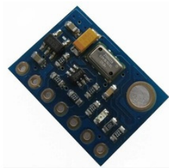
(a) Sensor de temperatura e pressão MS5611. fonte: http://dx.com
