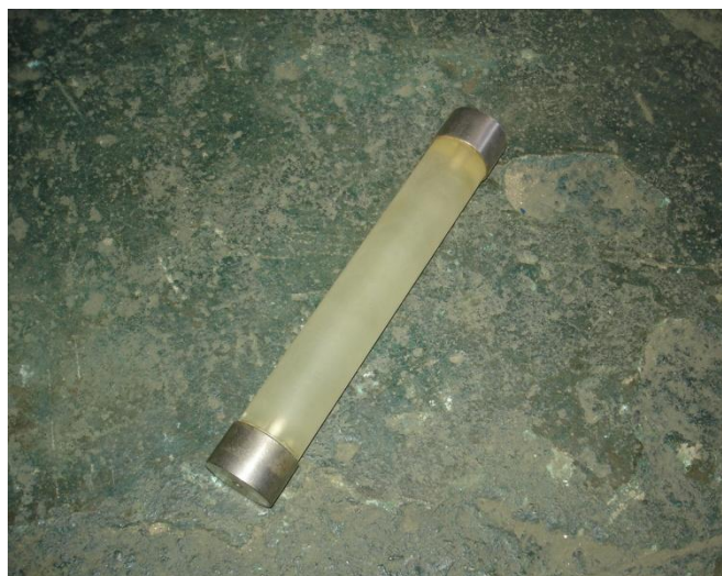
Fig. 5.9. Isolador de fibra de vidro.
