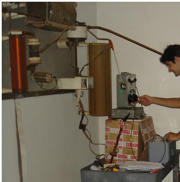
Fig. 2.6. Medição da impedância da antena.
