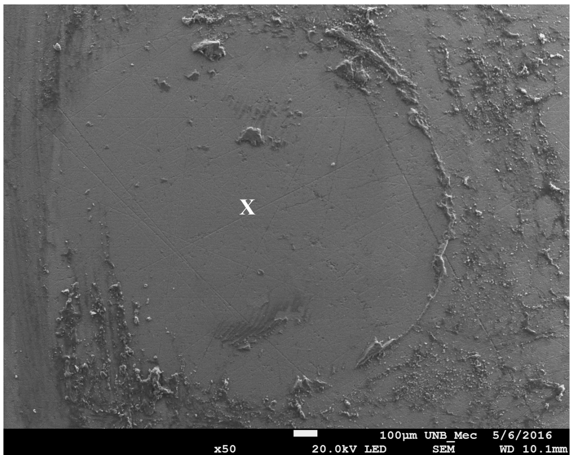
Figura 1 - Microscopia Eletrônica de Varredura de fratura adesiva em e.max CAD (G1). X – cerâmica tratada .
