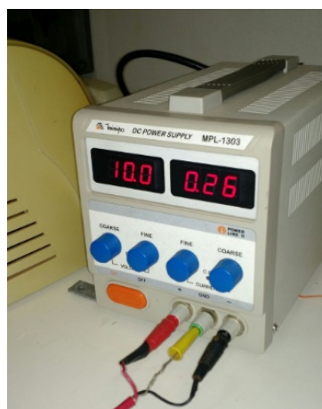
Figura 5.32: Conexão das placas à fonte elétrica.
