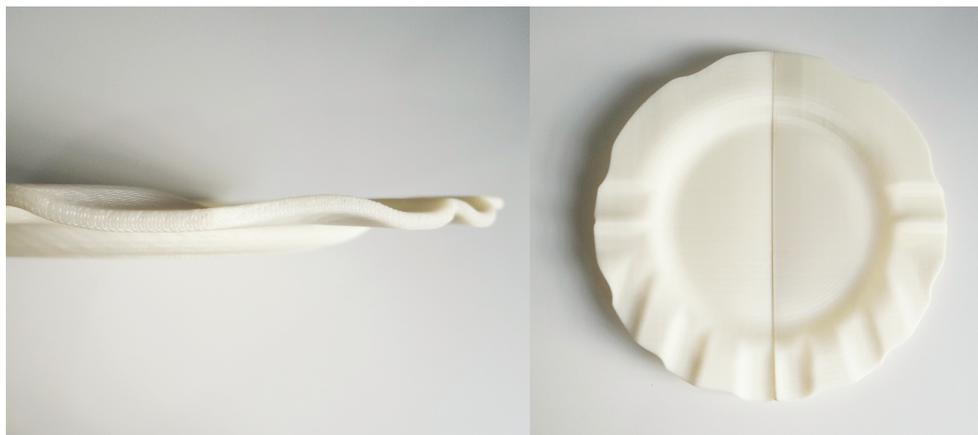
Figura 35 - Prototipagem rápida do prato principal
