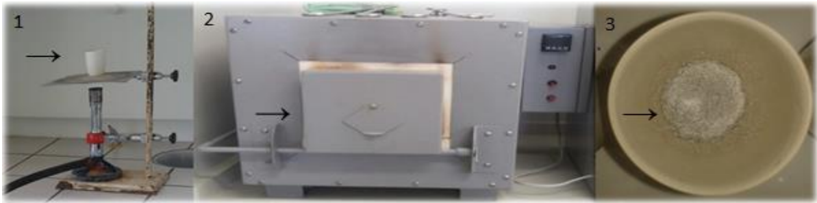
Figura 19. Ilustração do processo de obtenção do teor de cinzas totais das amostras vegetais. 1) Combustão prévia da amostra por bico de Bunsen, 2) incineração da amostra em mufla a 600°C/3 horas, 3) Cinzas obtidas após o processo de incineração. Fonte própria.
