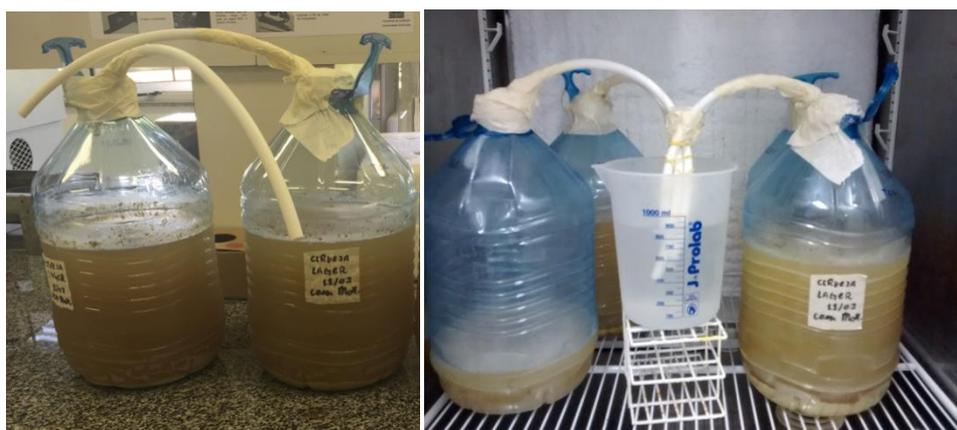
**Figura 12** – Fermentadores de 5 litros utilizados no processo de fabricação da cerveja artesanal.
