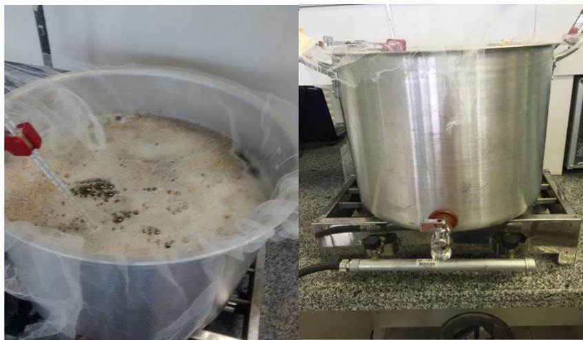
**Figura 7** – Mosturação do malte realizada durante o processo de fabricação da cerveja artesanal
