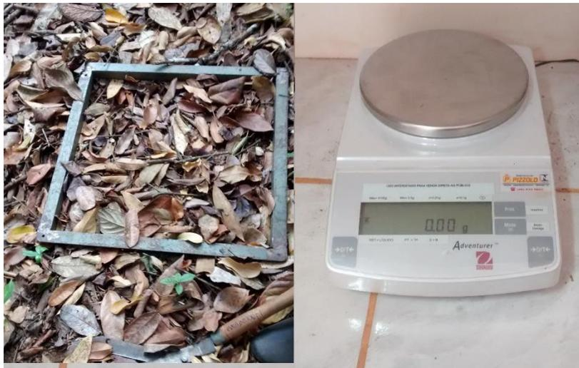
**Figura 6 – Observando de frente, na esquerda balança semi analítica utilizada para pesar as amostras de serapilheira vinda do campo e após serem secas. Na direita foto do gabarito utilizado para coleta das amostras de serapilheira.**
