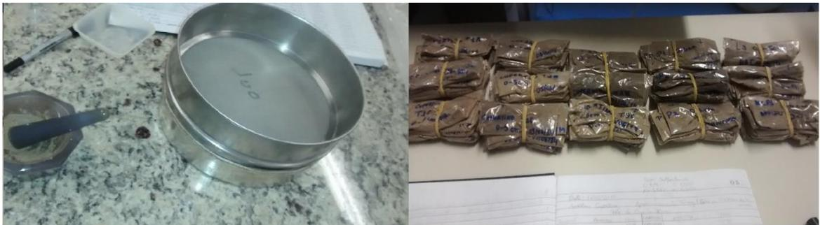
**Figura 5 – Observando de frente, na esquerda peneira de 100 mesh (0,149 mm) e almofariz utilizados para macerar as amostras de solo e serapilheira. Na direita amostras de solo após peneiradas.**
