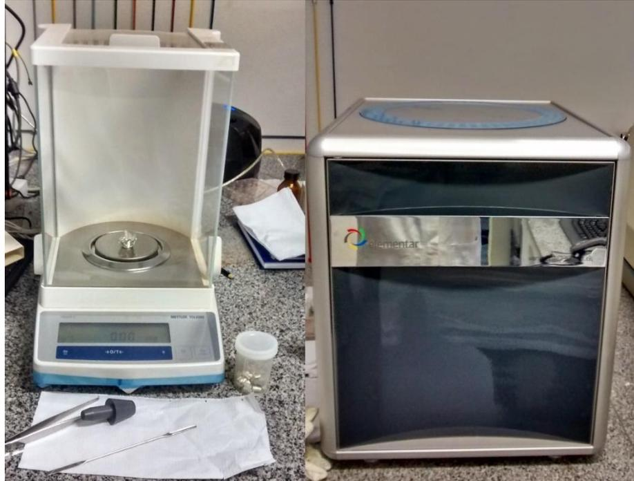
**Figura 7 – Observando de frente, na esquerda balança de precisão utilizada para pesar as amostras laboratoriais de solo e serapilheira. Na direita Analisador vario Macro cube CHNS - Elementar utilizado para fazer as análises.**
