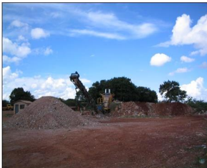
Figura 21- Mini usina de reciclagem de entulho no Aterro do Jóquei Clube. Fonte: (Rocha 2006).
