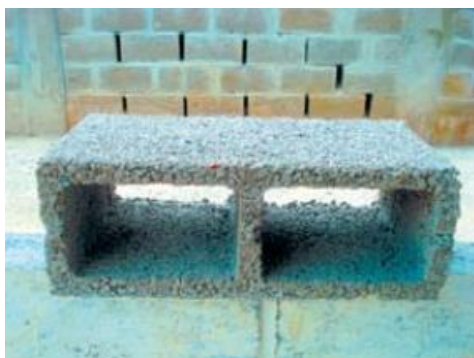
Figura 15– Ecobloco Originado de Resíduos tipo A. Fonte: (LANZA,2009).
