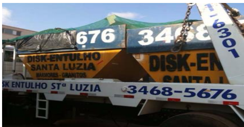
Figura 17- Caminhão poli-guindaste e caçambas Fonte: (Inojosa ,2011)
