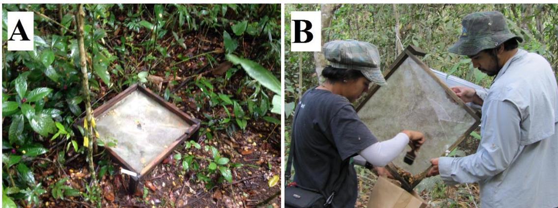
**Figura 4:** A) Coletor de madeira utilizado para a coleta da serapilheira. B) Processo de coleta na Mata Ripária.
