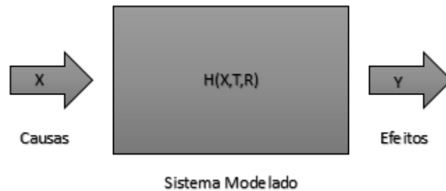
Figura 1 – Representação de um sistema linear invariante no tempo
