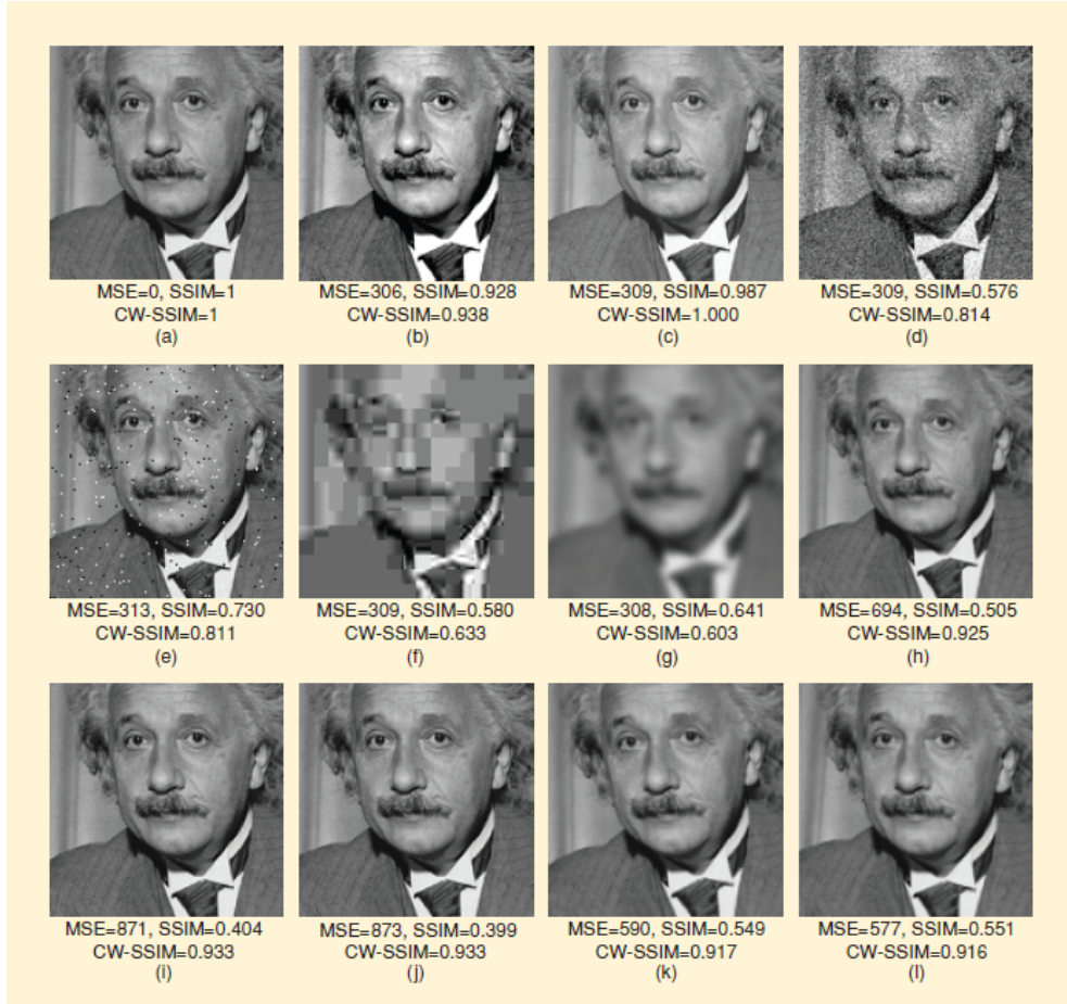
Figura 3.1: Exemplo de distorções que não são propriamente captadas pela métrica MSE mas são captadas pela métrica SSIM [7]. Temos: (a) Imagem de referência, (b) aumento de contraste, (c) mudança de luminância, (d) ruído gaussiano, (e) ruído impulsional, (f) compressão JPEG, (g) borrramento, (h) zoom out , (i) translação à direita, (j) translação à esquerda, (k) rotação anti-horária e (l) rotação horária.
